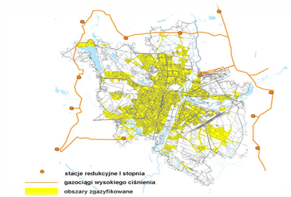
Rysunek 5. Schemat zasilania miasta Poznania z sieci gazowniczej wysokiego ciśnienia
