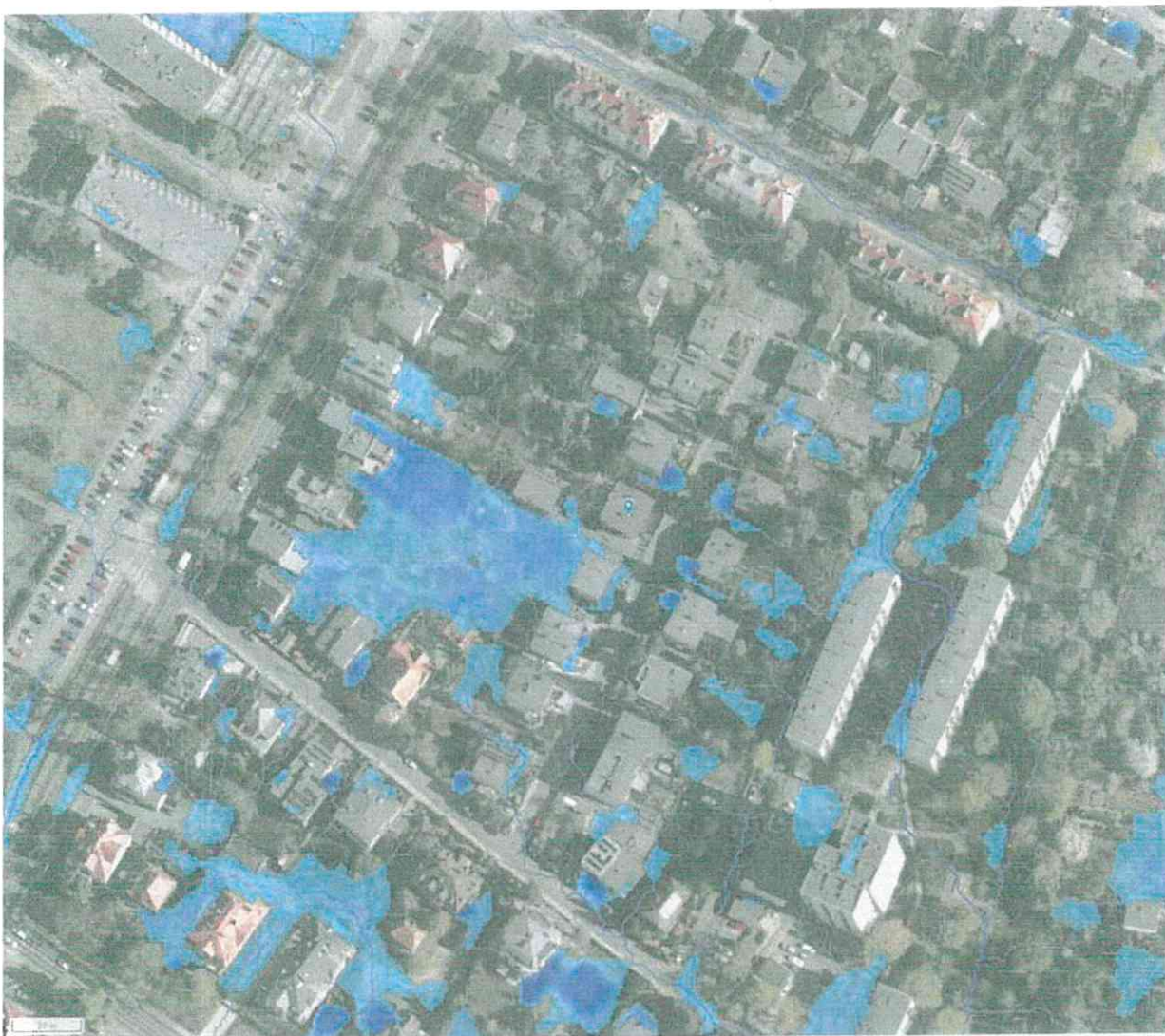
Fot. 1. Mapa przedstawiająca rejon ul. Wice z zasymulowanym opadem w wysokości 60 mm.
