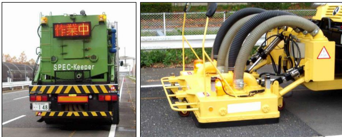
Rys. 74. Po lewej - samochód do czyszczenia cichych nawierzchni; po prawej - czyszczenie nawierzchni przy wykorzystaniu sprężonego powietrza (źródło: Noise reducing pavements in Japan - study tour report, Danish Road Institute, 2005, DRI-DWW noise abatement program)
