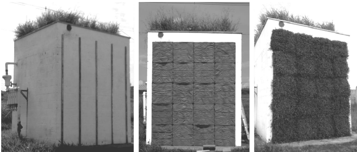
Rys. 57 Zielone ściany (green walls) o wysokim współczynniku pochłaniania jako rozwiązanie redukujące hałas w kanionach ulicznych; od lewej – Konfiguracja I – ściana z zamontowanymi słupami stalowymi, Konfiguracja II – ściana z 20 panelami ze sklejką na stalowych słupach + kieszenie z geowłókniny + podłoże; Konfiguracja III – jak w II + roślinność (źródło: jw)
