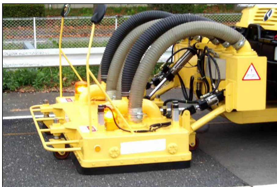
Rys. 43. Czyszczenie cichej nawierzchni drogowej przy wykorzystaniu sprężonego powietrza (źródło: j.w.)
