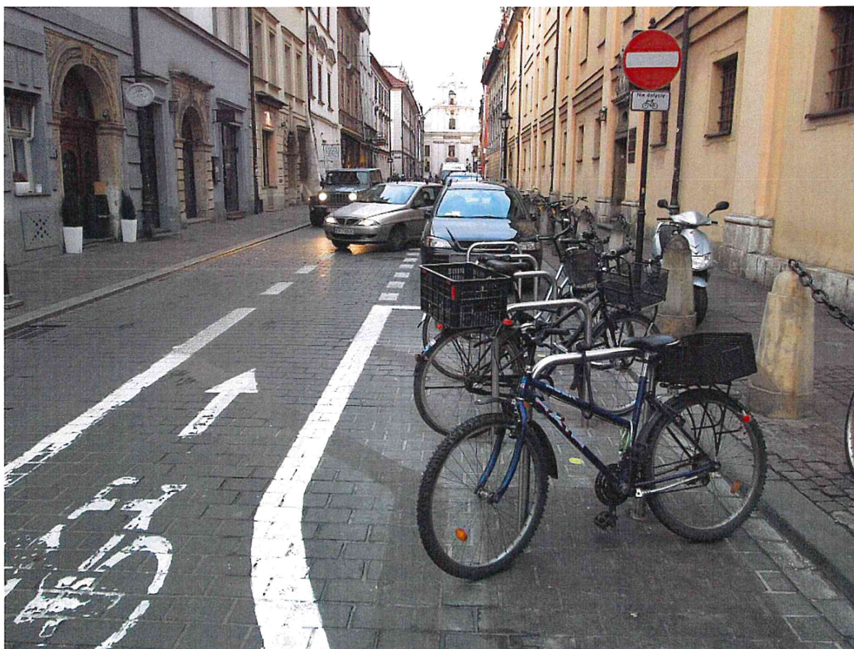
Fot. 16. Stojaki rowerowe zlokalizowane na jezdni w obrębie skrzyżowania. Poprawia to widoczność wzajemną i eliminuje ryzyko nieprawidłowego parkowania. Ul. św. Jana, Kraków.
