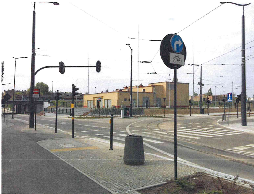
Oznakowanie zakończenia dwukierunkowej drogi dla rowerów w miejscu połączenia z wylotem jednokierunkowej drogi dla rowerów za pomocą znaku B-2 oraz C-2 z tabliczką T-22 na ul. tramwajowej w Łodzi.
